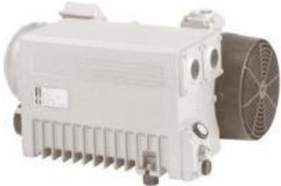
Пластинчато-роторный вакуумный насос **BUSCH RA 0100 F** с замкнутым режимом смазывания предназначен для непрерывного откачивания воздуха до давления 0,1 мбар. Мощность двигателя 2,2 кВт.
