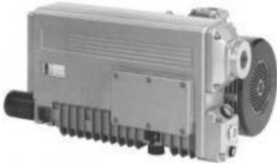
Пластинчато-роторный вакуумный насос **BUSCH RA 0160 D** с замкнутым режимом смазывания предназначен для непрерывного откачивания воздуха до давления 0,1 мбар. Мощность двигателя 4 кВт.
